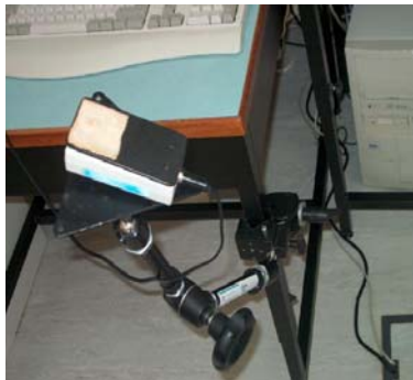
Figura 3: switch de queixo que a utente da APPC utilizou para testar a aplicação
